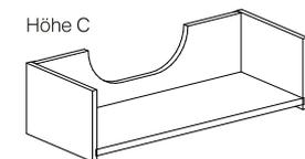
Ein Siphonausschnitt wird benötigt, wenn trotz Verwendung eines Raumparsiphons, die Unterseite oder die Rückwand der Schublade mit dem Siphon kollidieren würde. Die Position des Siphonausschnitts (falls notwendig) richtet sich nach dem Waschbecken oder Angaben des Kunden.
