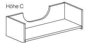
Ein Siphonausschnitt wird benötigt, wenn trotz Verwendung eines Raumsparnsiphons, die Unterseite oder die Rückwand der Schublade mit dem Siphon kollidieren würde. Die Position des Siphonausschnitts (falls notwendig) richtet sich nach dem Waschbecken oder Angaben des Kunden.
